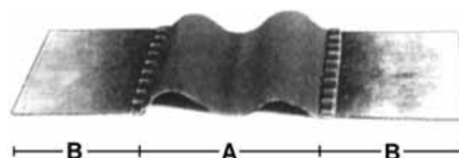
Detalle engatillado junta - fleje metálico
