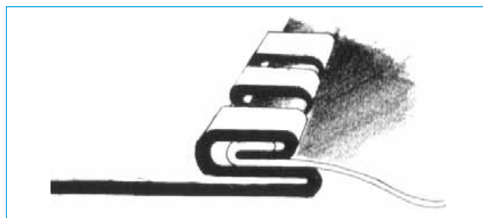
Detalle engatillado junta - fleje metálico
