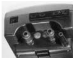
Dos entradas \Delta P para medición de tiro y presión
