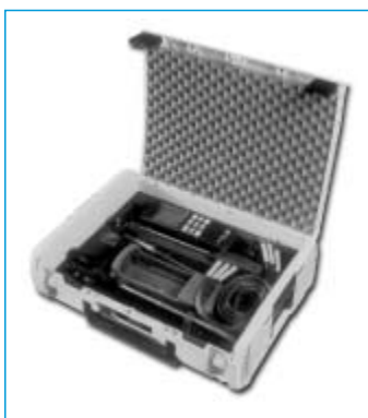
Dos entradas \Delta P para medición de tiro y presión
