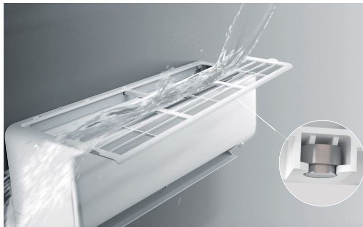
No es necesario abrir el panel frontal para acceder al filtro de aire. Gracias a 6 imanes en el filtro, se puede desmontar y volver a montar con un solo suave "click"
