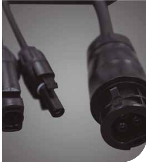
▲ Detalle conexiones de continua y de alterna en el microinversor.
