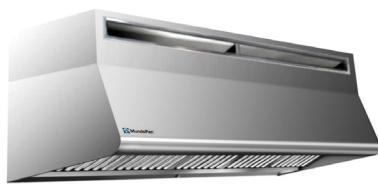
Campana de elevada calidad y gran diseño. Posee un plenum y rejilla para aportación de aire exterior. Es necesaria su instalación en cocinas sin entrada de aire natural, climatizadas, que superen los 5 m o en climas extremos. El caudal a aportar suele ser entre el 70-80% del caudal de extracción.
