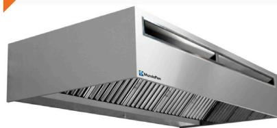
**Campana de elevada calidad y gran diseño. Reversible.** Posee un plenum y rejilla para aportación de aire exterior. Es necesaria su instalación en cocinas sin entrada de aire natural, climatizadas, que superen los 5 m o en climas extremos. El caudal a aportar suele ser entre el 70-80% del caudal de extracción.
