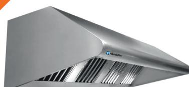
Campana de elevada calidad y diseño. Sistema de aportación de aire exterior mediante una bóveda de inducción dentro de la propia campana. Es necesaria su instalación en cocinas sin entrada de aire natural, climatizadas, que superen los 5 m o en climas extremos. El caudal a aportar suele ser entre el 50-60% del caudal de extracción.
