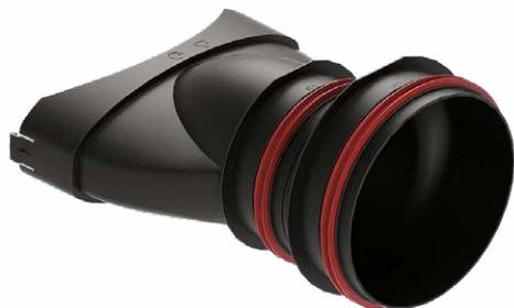
El conector lateral se utiliza para conectar el suministro principal de aire o la tubería de escape de aire a cualquier lado de la caja de distribución. Está diseñado para fijarse en la ranura ovalada a ambos lados de la caja de distribución en sustitución de un módulo de 3x75. Si se utiliza un tubo de 125 mm de diámetro, se debe cortar la parte no utilizada.
